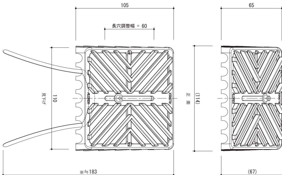
※ステンレスストッパーを含む全長は前面の調整ネジの位置により変わります。
