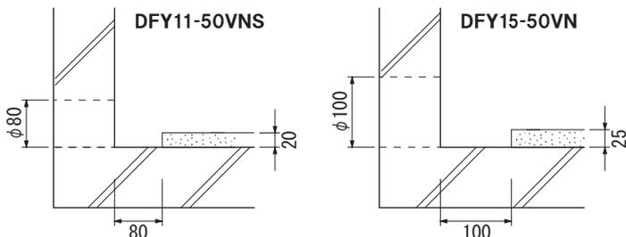
※ホルソーを使用する事により、より正確な穴加工ができます。
