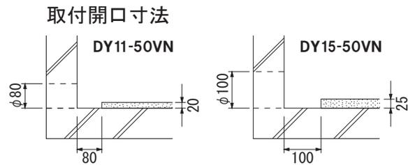
※ホルソーを使用する事により、より正確な穴加工ができます。
