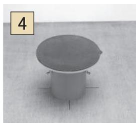
4 打設中生コンが本体に流入しないように養生蓋をドレイン本体上部にかぶせて下さい。
