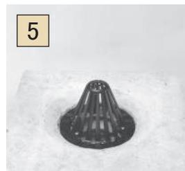
5 独立型防水層押えをネジで取り付けます。モルタル仕上げ後、カバーを丸小ネジ 5×16 3本で取り付けてください。
