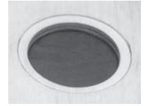
ホルソーにて塩ビパイプ通し穴加工(φ90)
